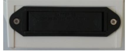
Um das Batteriefach zu öffnen, muss an den beiden Seiten, die Plastiklasche nach innen gedrückt werden. Dies erfordert eine gewisse Kraftanstrengung. Die Batterieschublade zeigt an, wie und mit welcher Polung die Batterien eingelegt werden müssen. Diese Hinweise auf jeden Fall beachten.
