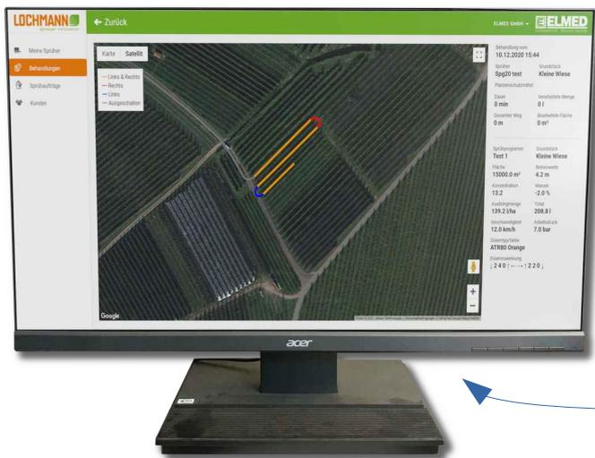
Ricorrendo a un browser Internet è possibile monitorare su un PC (o smartTV, tablet, ecc.) lo stato dell'atomizzatore.
