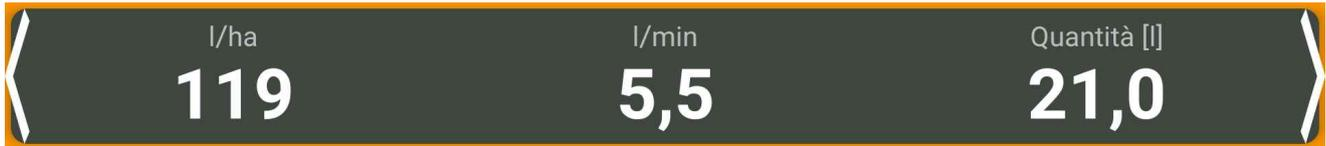
**Fig. 6: Barra informazioni con indicazione di volume di distribuzione, portata e quantità totale**
