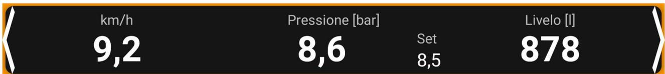
Fig. 3: Barra informazioni con indicazione di velocità, pressione e livello del serbatoio
