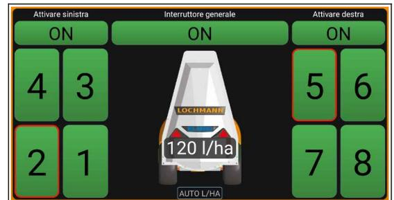
Fig. 26: Display di visualizzazione sezioni
