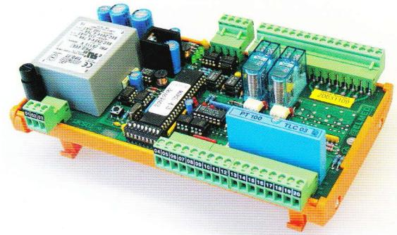
Dieses Modul \*, das direkt am Tank montiert werden kann, steuert nun einen Stellmotor, der den Tank über ein Kühl- oder Heizkreissystem auf die gewünschte, vorprogrammierte Temperatur bringt.
