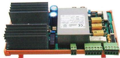
Über das Modul RAL01 werden die Beregnungsanlagen geregelt. Über eine serielle Schnittstelle können alle Daten, z.B. wie Ein- und Ausschalten an die Ventile gesendet werden.
